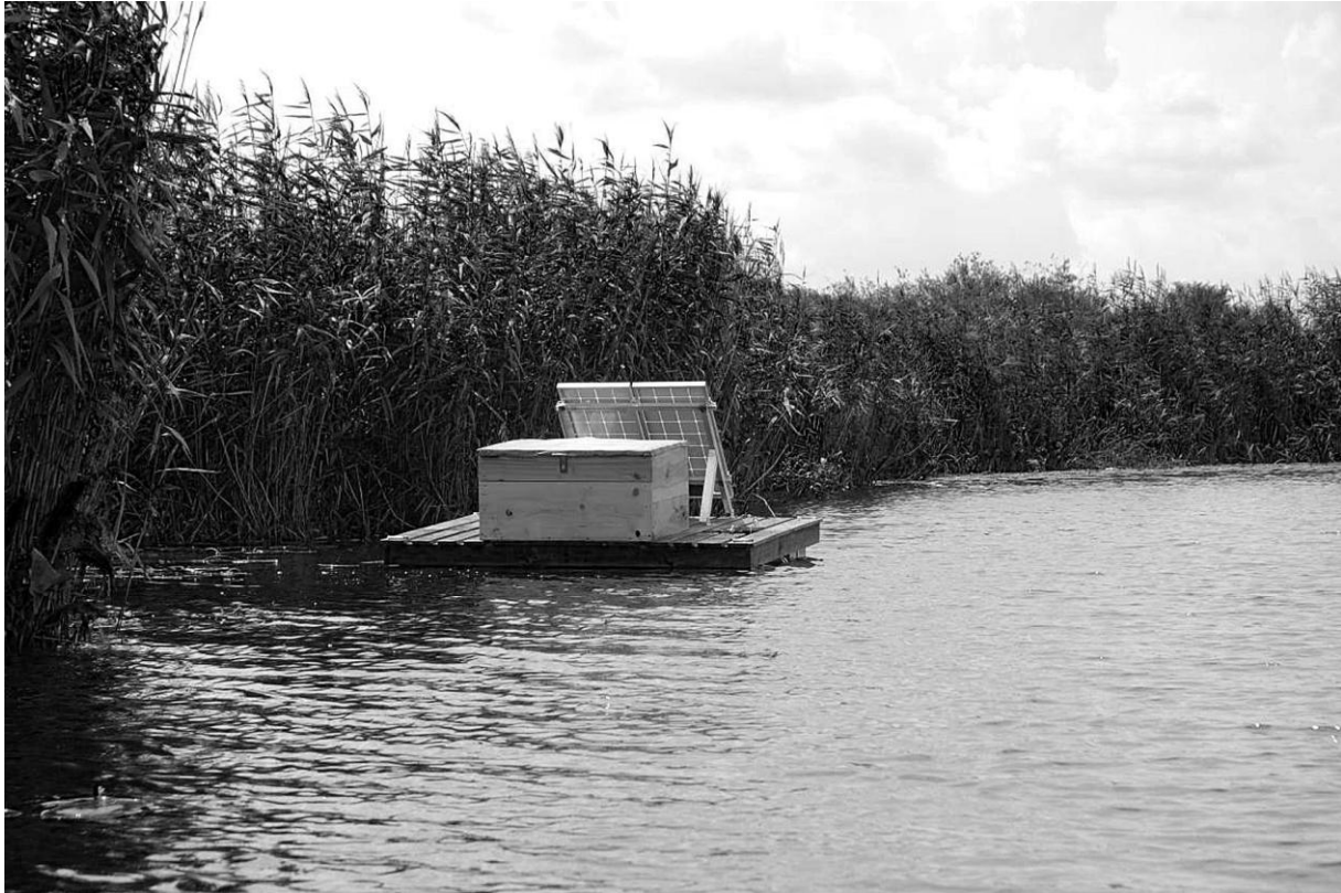
Abb. 5: Floß mit Aufbau für Bioreaktoren, durch welche mittels solar betriebenen Pumpen Wasser gepumpt wurde, um den Abbau von Schadstoffen zu untersuchen. Außerdem konnten unter dem Floß Objektträger als Aufwuchsfläche für Biofilme exponiert werden.
