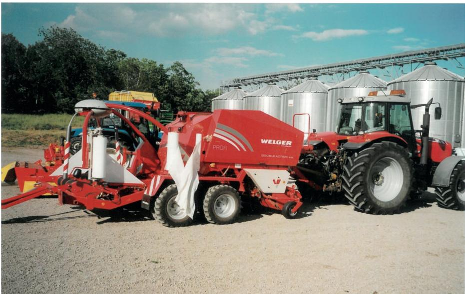
Abb. 1: Zu kleine Räder einer schweren Heupresse – laufen schmal in einer Spur
