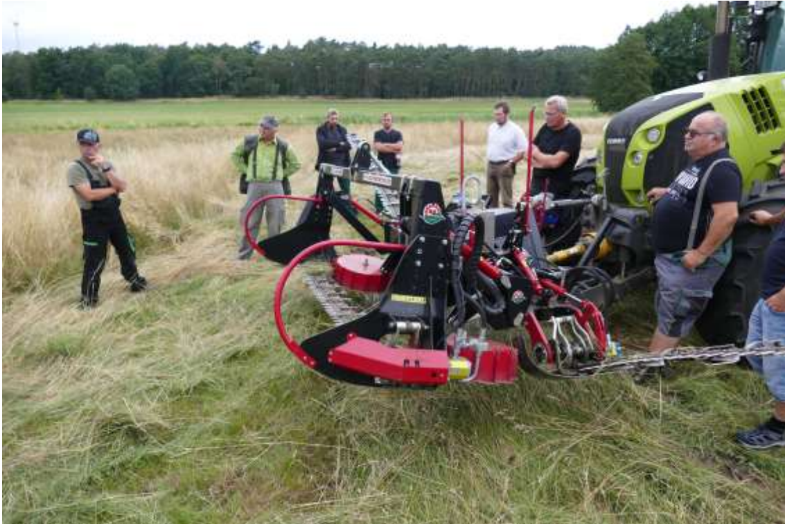
Abb. 2: Einsatz eines Doppelmesser-Balkenmähers im unteren Odertal: Im Sommer 2021 wurde von der Firma BB-Umwelttechnik (Roßhaupten) ein moderner, dreiteiliger Doppelmesser-Balkenmäher im Einsatz den ortsansässigen Landwirten präsentiert, die sehr zahlreich zu diesem Demonstrationstreffen, einem wirklichen Bauerntag, gekommen waren. Wenn auch die Vorführung nicht ganz pannenfrei verlief, so motivierte sie doch die ortsansässigen Landwirte über den Einsatz von Doppelmesser-Balkenmähern einmal etwas gründlicher nachzudenken.
