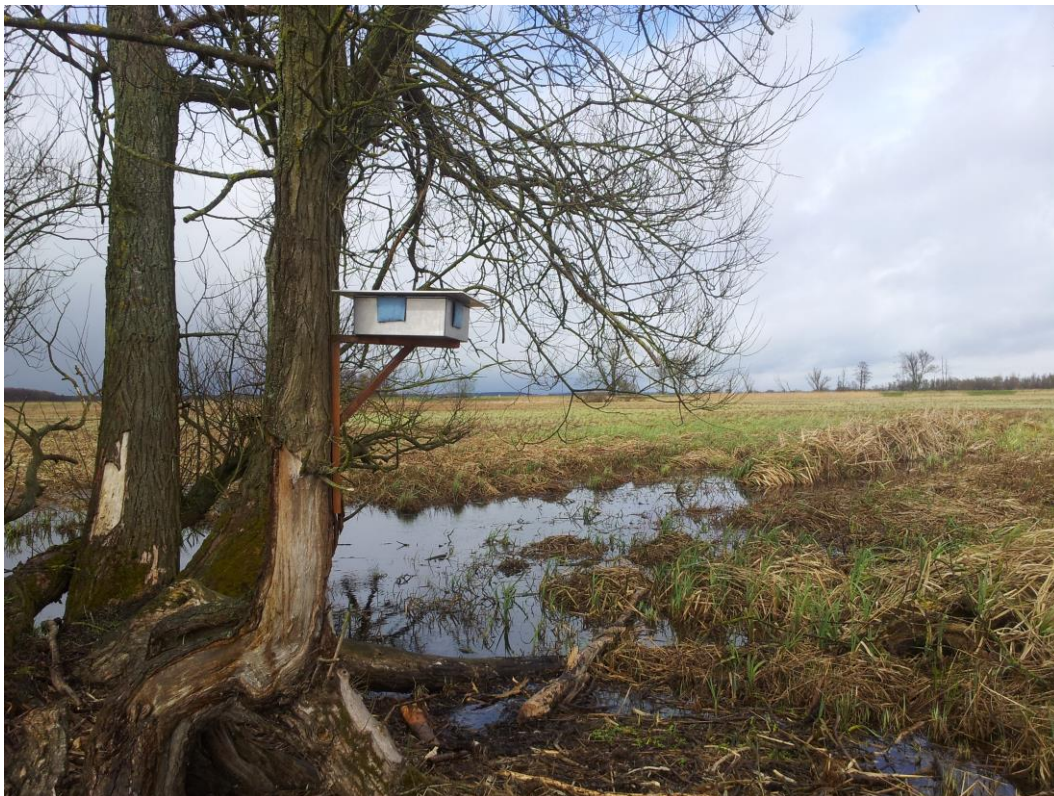
Abb. 2: Automatische akustische Aufzeichnungseinheit im Nordteil des Polder 10. Die Mikrofone sind in der Wandung des Aluminiumgehäuses montiert. Ein Flies fungiert als Windschutz (Foto: K.-H. Frommolt)
